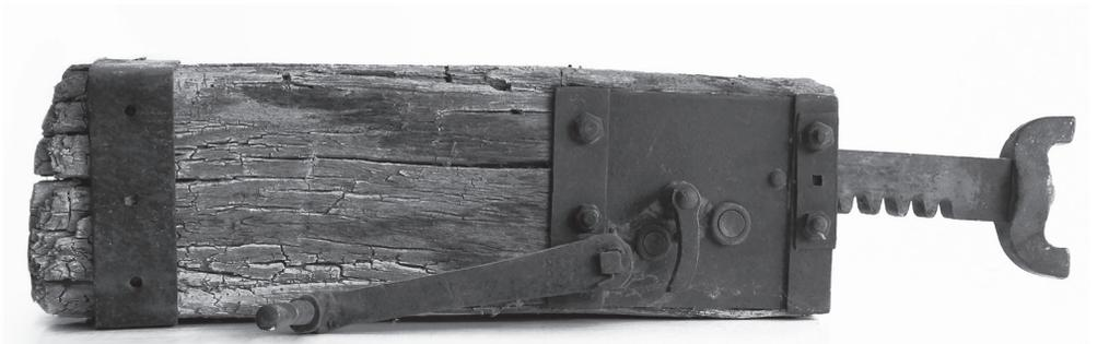
Antiguo gato utilizado para levantar bloques en la cantera y en la fábrica. Pieza de fundición y madera de olivo. Siglo XIX. Fotografía: Colección del autor.
