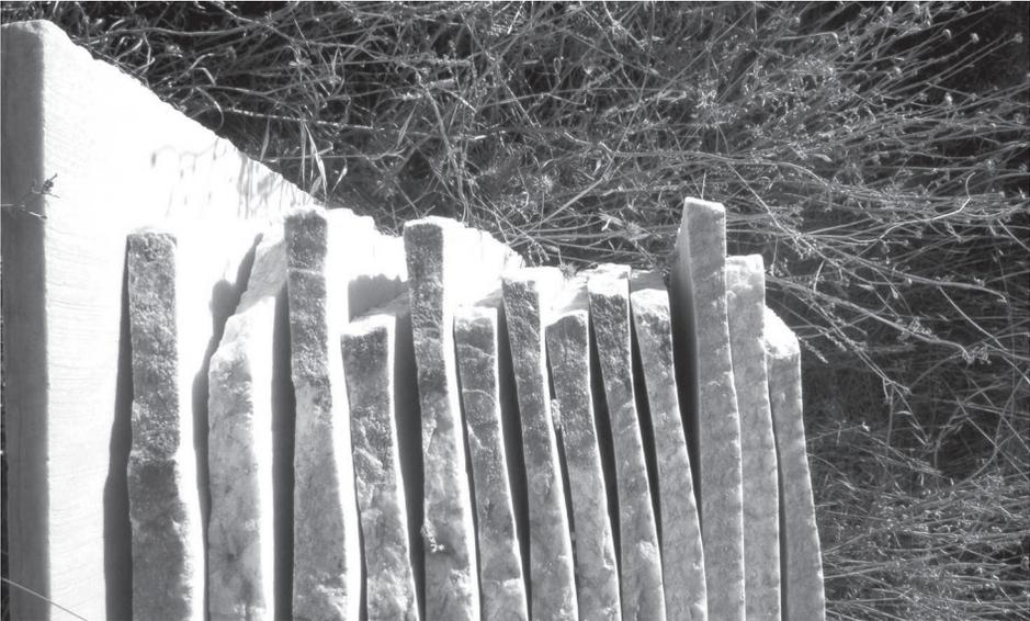
Aserrá torcía. La dureza del material conlleva el desvío en el corte del bloque. Fotografía: Colección del autor.
